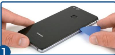
**1** Handy Backcover mit dem Föhn erwärmen, um den Klebstoff zu lösen, dann mit dem Saugnapf und Plektrum öffnen.
