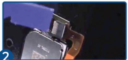
**2** Display aufklappen und Konnektor des Fingerabdrucksensors lösen, danach komplett öffnen.
